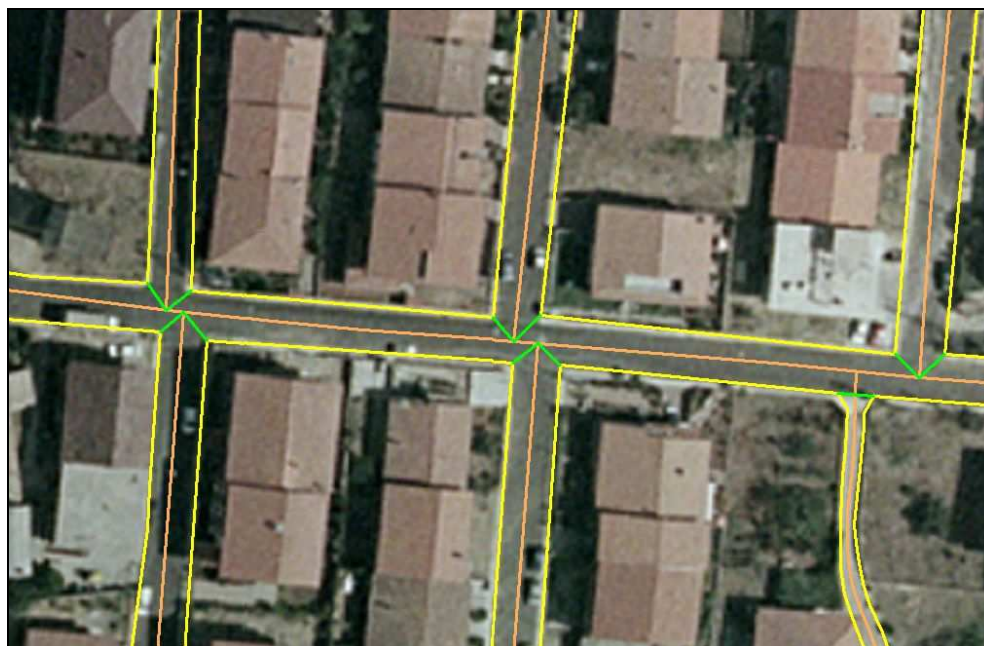
Fig. 7: Segmentazione dell'area stradale in zona urbana. Le linee in giallo rappresentano la perimetrazione dell'area stradale, in arancio è raffigurato il grafo di dettaglio (GDF1) e in verde la suddivisione dell'area stradale in corrispondenza d'incrocio tra 2 strade aventi la stessa classifica tecnico-funzionale.
