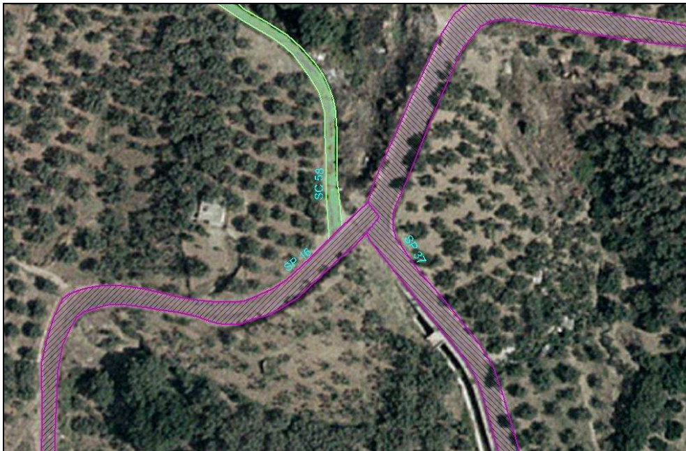
Fig. 6: Segmentazione dell'area stradale in corrispondenza degli incroci tra 2 strade a differente classifica funzionale (una strada comunale ed una provinciale) e tra 2 strade a uguale classifica funzionale (2 strade provinciali).
